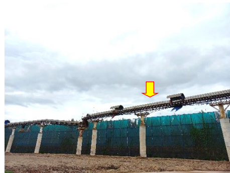
ภาพที่ 2.2-9 การปิดครอบระบบสายพานลำเลียง
