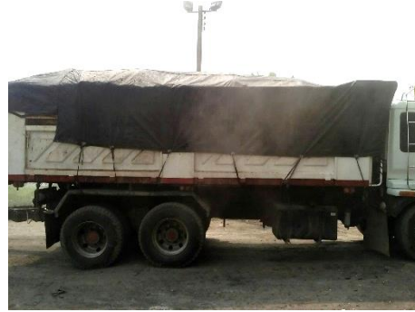
ภาพที่ 2.2-15 การปิดคลุมกระบะรถบรรทุกขนย้ายเถ้า
